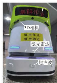
图 14 环卫机器人结构
